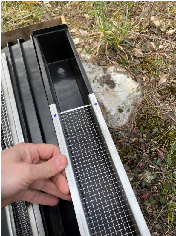
Slika 12. Modifikacija klopke sa dizajniranom pocinčanom mrežicom kojima se značajno smanjuje ulov prirodnih neprijatelja
